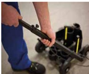
1. Montare il manico e fissarlo con la vite
