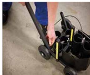
2. Fissare il manico al carrello, quindi avvitare. Il dispositivo per la marcatura può essere spostato allentando la vite. Il dispositivo di scorrimento consente di trovare l'impostazione corretta
