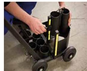
3. Il dispositivo per la marcatura può essere spostato a destra o a sinistra del carrello per eseguire la marcatura laterale.
