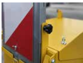
SISTEMA DI BLOCCO A MOLLA
